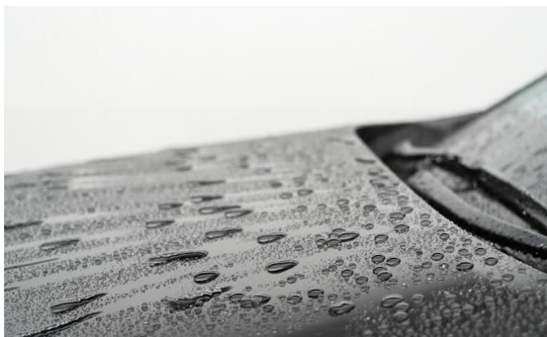
ボディシーラントは反応タイプのコーティング剤ですので、ツヤ感手触り感は施工後すぐ出ますが、超撥水が始まるのは施工約半日後からになります。(夏場はもっと早め)
