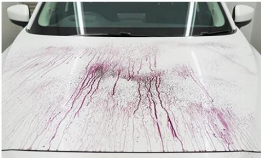
鉄粉除去剤をポンプスプレーに入れ、ボディ全体に噴霧してください。1~2分程度で付着した鉄粉が紫色に反応してきますので、その後十分な水を掛けながら、洗車用スポンジで鉄粉除去剤を洗い流してください。
